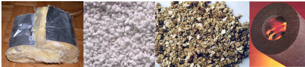
Isolatiematerialen uit minerale grondstoffen. Vlnr: Glaswol, perliet, vermiculiet, cellenglas Bron vlnr: VIBE vzw, www.travellersgarden.vom, VIBE vzw, Foamglas
